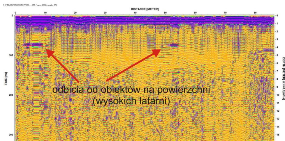
Ryc. 2. Echogram zarejestrowany w miejscowości Piwniczna-Zdrój, na drodze wzdłuż Popradu. Anteny nieekranowane 200MHz
